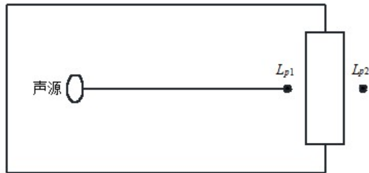
图 5.4-1 室内声源等效为室外声源图例
