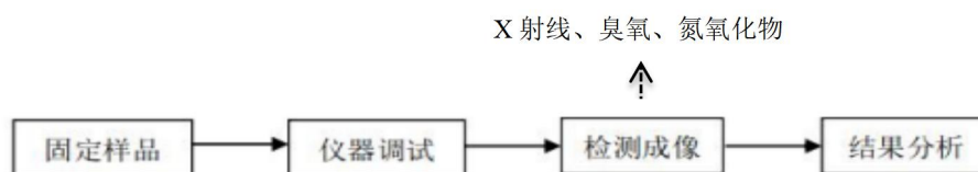
图 9-3 无损检测工艺流程
